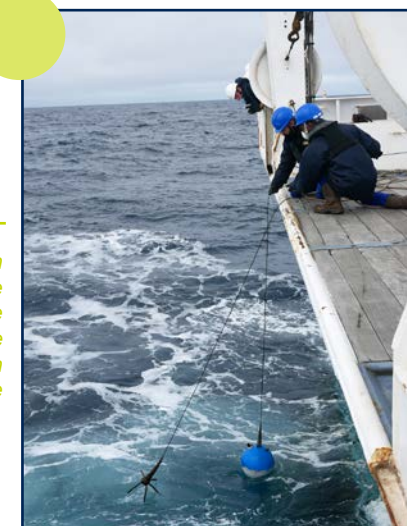
Récupération d'une bouée de mesure de température de surface pour vérification métrologique
